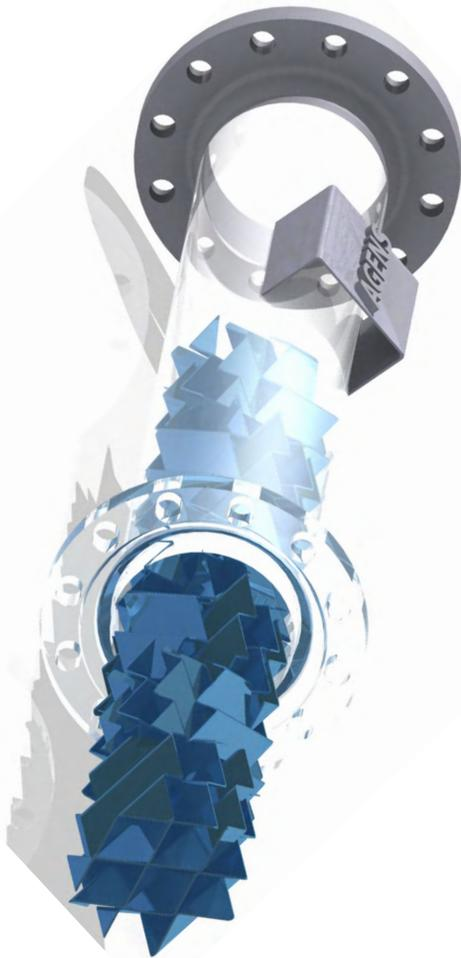
Bei einem AGENS AMV – Mischer werden die ankommenden Ströme zusätzlich in einzelne Teilströme aufgeteilt und an den Kreuzungsstellen der Kanäle abgesichert. Durch diese Methodik der geordneten Aufteilung und Verlagerung ist der AGENS AMV unempfindlich gegen Durchsatzschwankungen.
